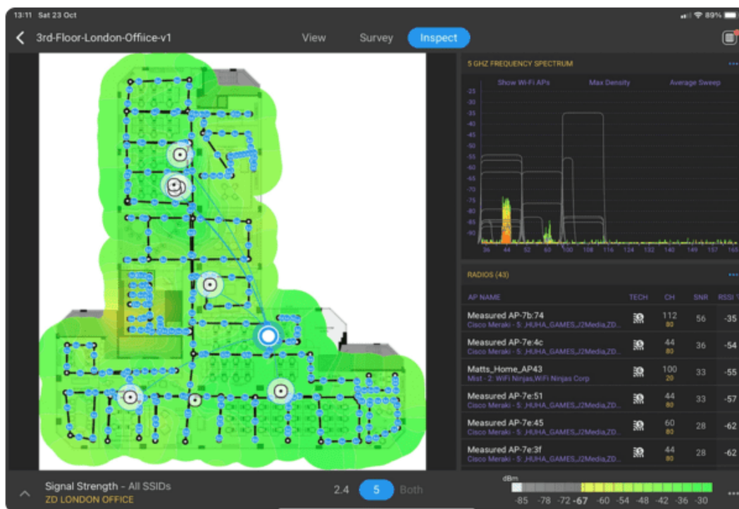
Figura 4 - Exemplo de Wireless Site Survey utilizando o Ekahau
